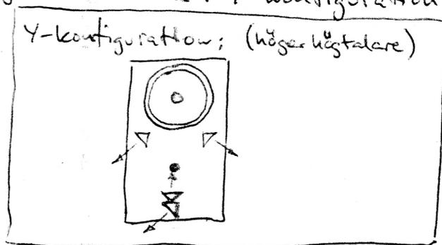
Persönligen tycker jag att lite av det som är (eller var) just OA-5, går förlorat med Y-konfigurationen, även om faktorer som tydlighet i stereobilden och lokalisering förbättras. De som är experimentlystna kan testa denna diskant-elementplacering:
