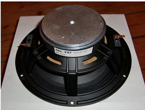
Obi F87 "9710", bakifrån – det specialgjorda baselementet som ersätter Philips 9710. Notera de på ömse sidor utgående anslutningarna, som ger symmetri och gör att konen inte så lätt hamnar i rocking-mode.
