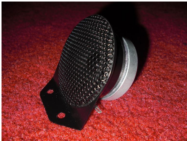
Obi T22-oa – specialgjort diskantelement för montering uppe på en plan yta. Vinkeln väljer man genom att försänka magnet-systemet lagom mycket i baffeln.
